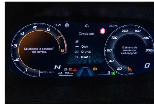
Tableau de bord numérique avec indicateur de puissance (powermeter) et indicateur « OFF » ou « READY », présenté ici comme un exemple de la famille eHybrid.
