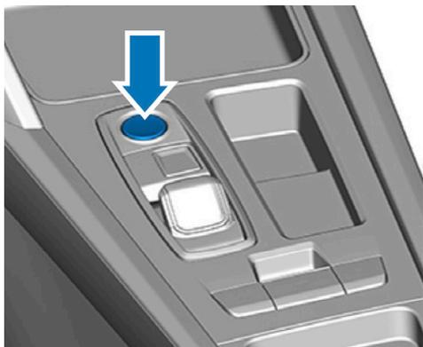
Véhicule avec bouton « START ENGINE STOP » sur la console centrale.
