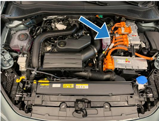
Câbles haute tension orange dans le compartiment moteur
