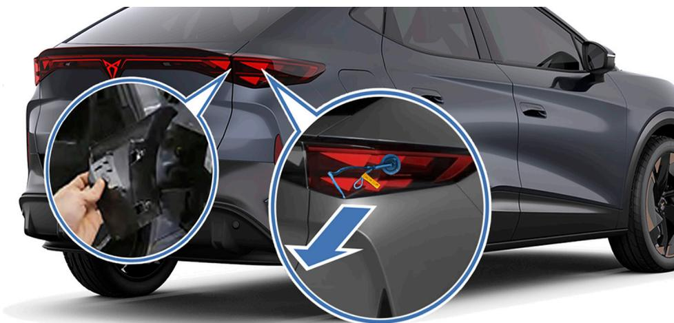
Dispositif de coupure à l'arrière du véhicule, derrière le feu arrière droit. (Exemple du TAVASCAN)
