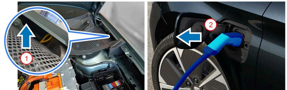
Exemple d'emplacement du déverrouillage d'urgence de la station de recharge (LEÓN PHEV) :
