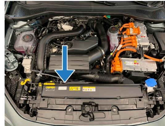
Étiquettes de danger électrique dans le compartiment moteur.
