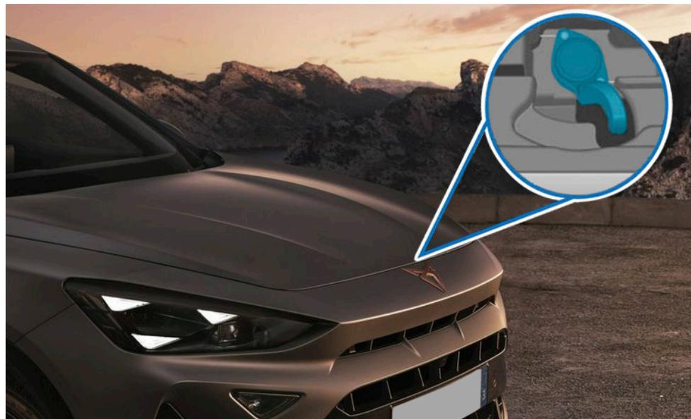
Sur le capot avant : levier de déverrouillage.
