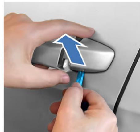
Retirer le couvercle en faisant levier avec la clé
