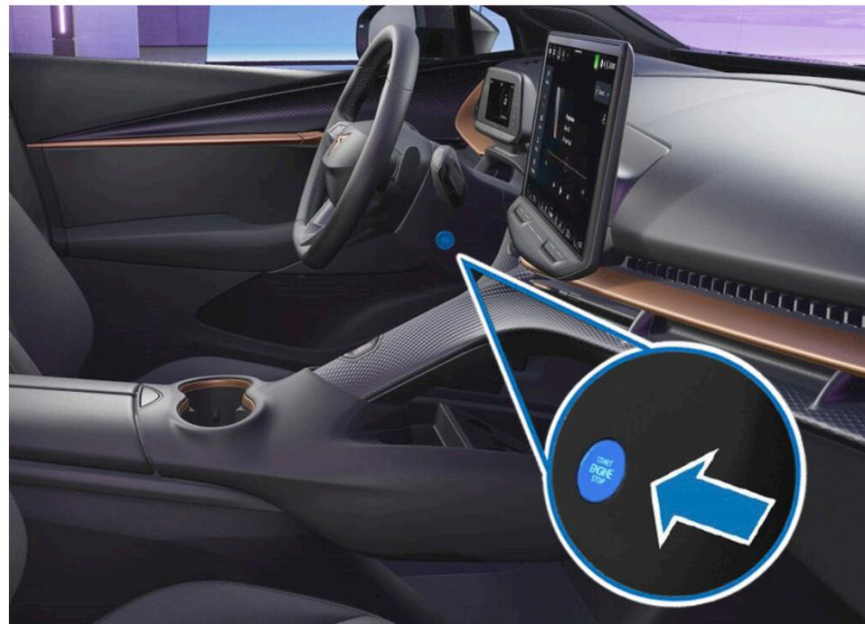
Vehículo con pulsador “START-ENGINE-STOP” en la columna de dirección.
