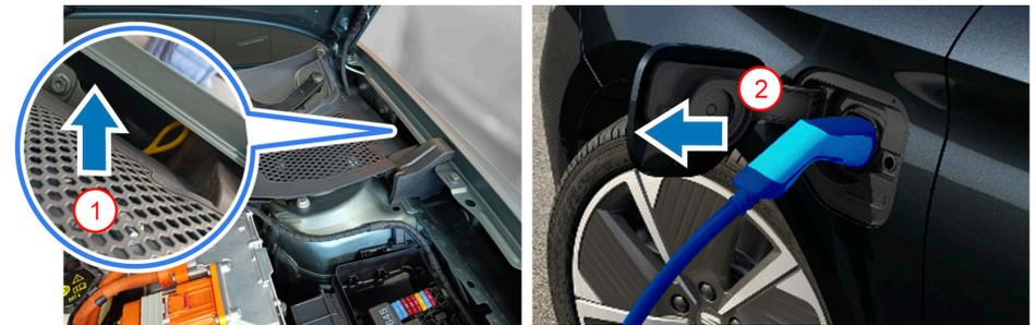
Ejemplo de la ubicación del desbloqueo de emergencia de la estación de carga (LEÓN PHEV):
