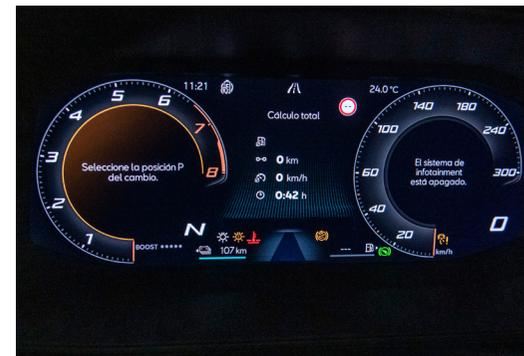
Cuadro de instrumentos digital con indicador de potencia (powermeter) e indicador "OFF" o "READY", mostrado aquí como ejemplo en la familia eHybrid.
