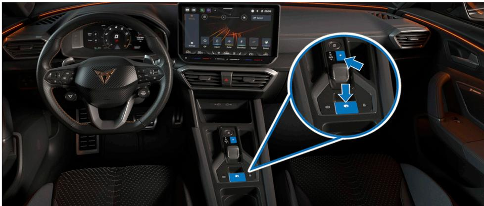
**Vehículo con cambio automático sin palanca selectora: pulsar la tecla “P” y accionar el freno de mano eléctrico.**
