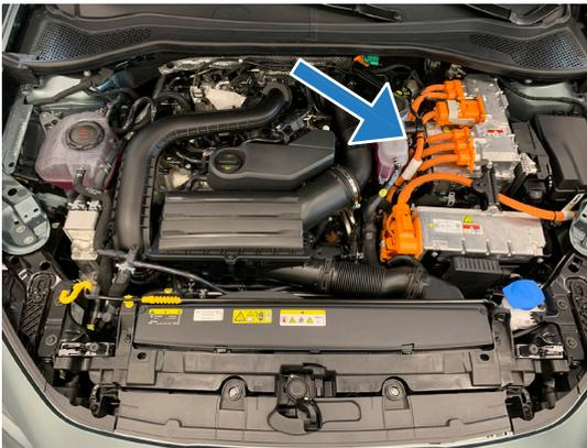
Cables de alto voltaje de color naranja en el vano motor
