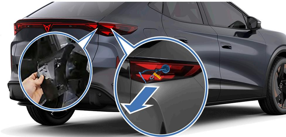
Punto de corte en la parte trasera del vehículo, detrás del piloto trasero derecho. (Ejemplo del TAVASCAN)
