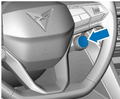
Vehículo con pulsador “START-ENGINE-STOP” en el volante multifunción.
