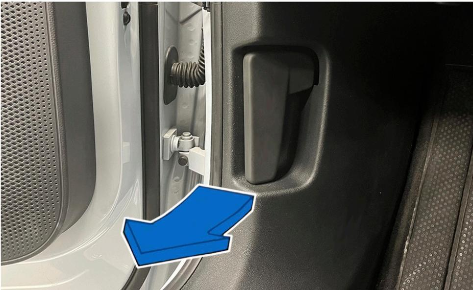
En la zona reposapiés del lado del conductor: palanca de desbloqueo del capó delantero.
