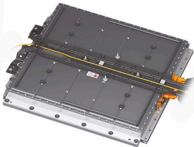
La batería de alto voltaje del BORN
