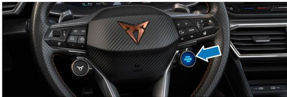
Pressionar o botão START-ENGINE-STOP, que se encontra no volante multifunções, sem pressionar o pedal do travão.
