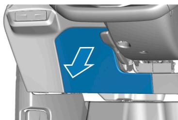
Liberar la tapa junto a la columna de dirección con un destornillador.
