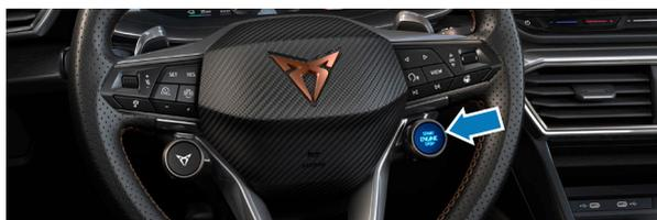
Presionar el pulsador START - ENGINE - STOP, situado en el volante multifunción, sin accionar el pedal del freno.
