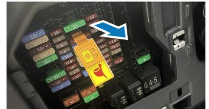
Ziehen Sie am Etikett, um die Sicherung zu trennen.
