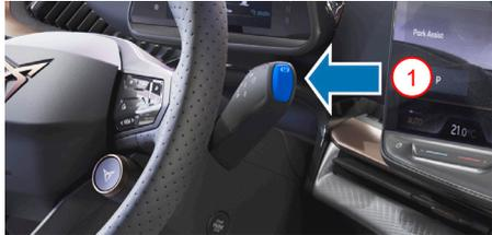
1. Die elektrische Feststellbremse betätigen.
