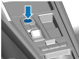
Presionar el pulsador START - ENGINE - STOP, situado (depende del modelo) en el volante multifunción o en la consola central, sin accionar el pedal del freno.
