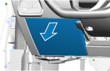
Liberar la tapa junto a la columna de dirección con un destornillador.
