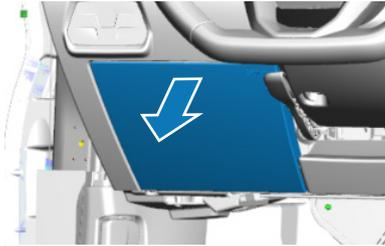
Desapertar a cobertura junto à coluna da direção com uma chave de parafusos.
