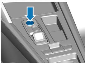
Pressione o botão START - ENGINE - STOP, que se encontra (consoante o modelo) no volante multifunções na consola central, sem pressionar o pedal do travão.
