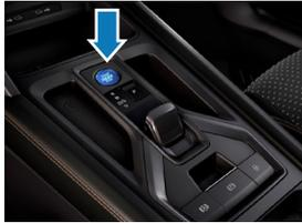
Appuyez sur le bouton START - ENGINE - STOP, situé (selon le modèle) sur le volant multifonction ou sur la console centrale, sans appuyer sur la pédale de frein.
