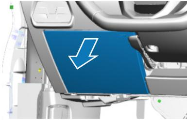
Déverrouillez le couvercle situé à côté de la colonne de direction à l'aide d'un tournevis.
