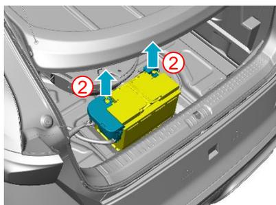
2. (Variante 2) Desembornar la batería de 12V en el maletero con las herramientas adecuadas. Desconectar el sistema eléctrico del vehículo: Desconectar primero el polo negativo (-) y después el polo positivo (+) de la batería de a bordo.
