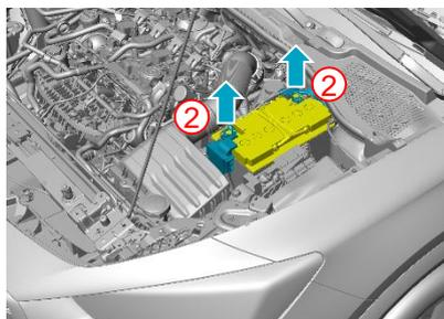
2. (Variante 1) Desembornar la batería de 12V en el vano motor con las herramientas adecuadas. Desconectar el sistema eléctrico del vehículo: Desconectar primero el polo negativo (-) y después el polo positivo (+) de la batería de a bordo.
